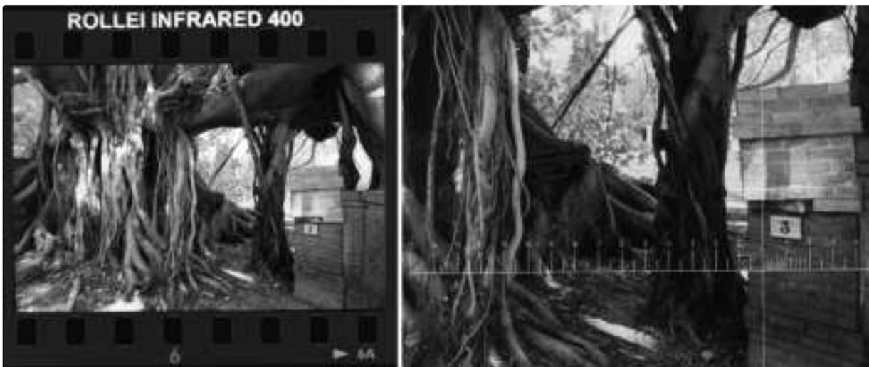
A confronto uno scatto pancromatico su Rollei Infrared e un ingrandimento: sulla negativa è stata appoggiata una diottra: i numeri indicano i millimetri, prima del n.1 si notano delle piccole linee bianche verticali che sono i decimi di millimetro. la risoluzione di 110 linee/mm della Rollei Infrared è pienamente confermata.
