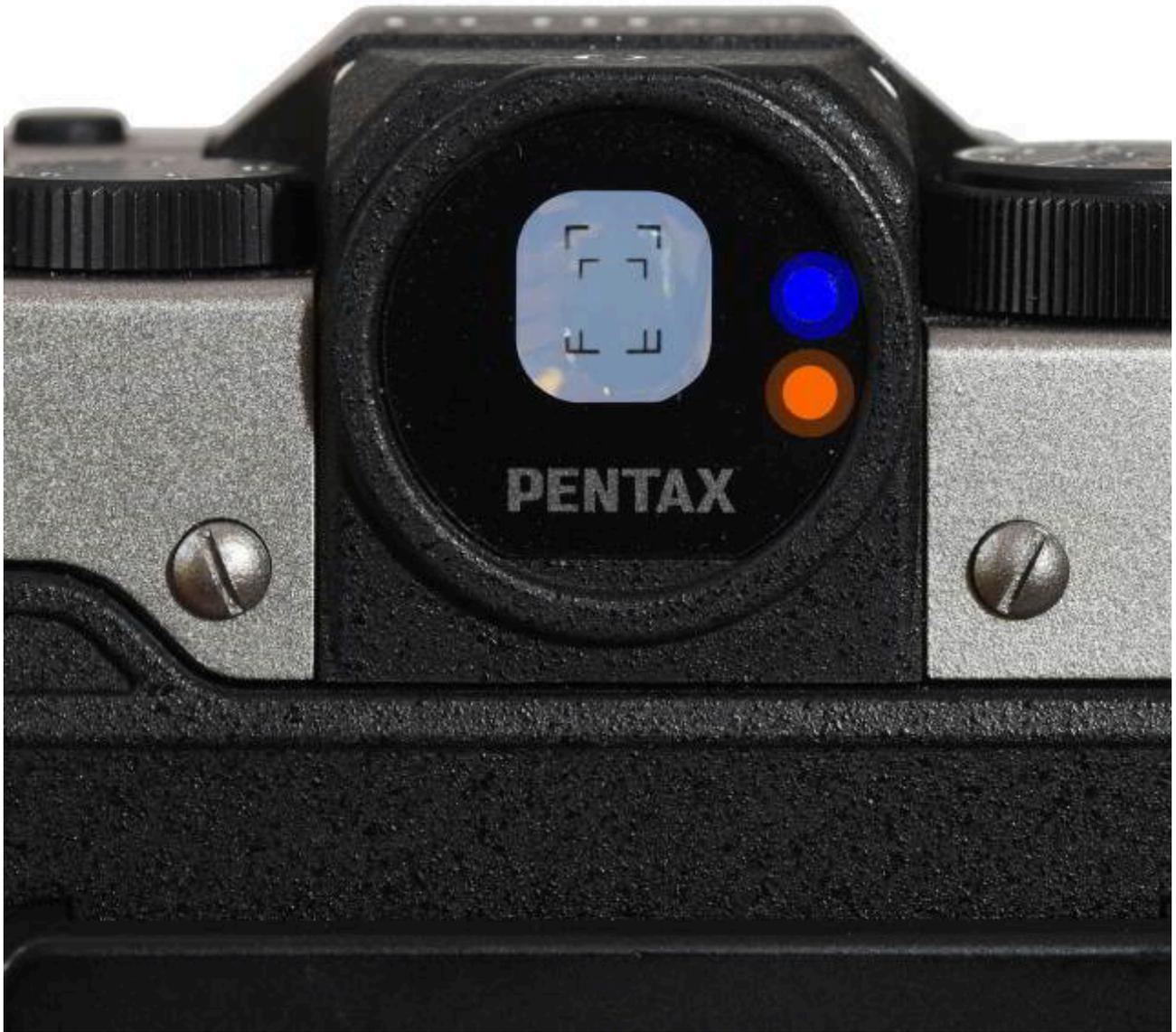
Il mirino è galileiano ma è posizionato esattamente sul punto nodale dell'ottica, con cornicette luminose che permettono di arrivare a visualizzare l'inquadratura ravvicinata che è di soli 25 centimetri. Due LED, uno arancione e uno blu avvisano l'utente di varie funzioni, dalla presenza del tappo sull'obiettivo, alla spia pronto flash.
