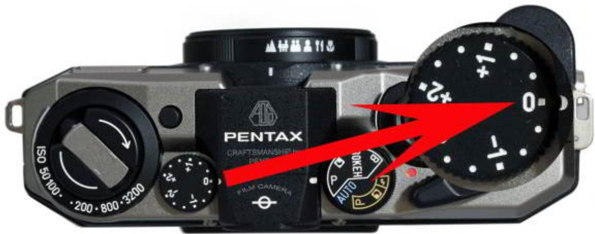
Proprio a motivo del fatto che la macchina è completamente automatica, è possibile nelle condizioni necessarie, effettuare una staratura intenzionale dell'esposizione che può andare da +2 a -2 EV sotto o sovraesponendo intenzionalmente a terzi di stop. Se anche questo non bastasse basta "forzare la sensibilità impostata per l'esposimetro per effettuare delle sotto o sovraesposizioni intenzionali che superano i +/-2 stop.
